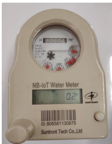
Figura 5. Medidor mecánico Suntront Tech con comunicación LoRa ( Statu Quo )
