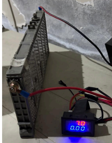
Voltaje inicial antes de descarga del módulo 28.
