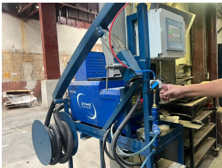
Figura 25 Verificación visual del enfriamiento de goma
