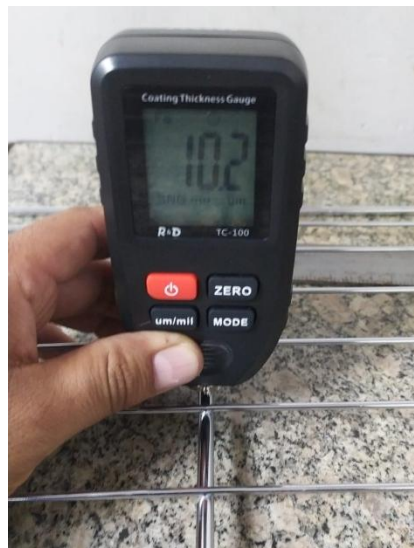
Figura 33. Medición de micra mediante el medidor de micras.
