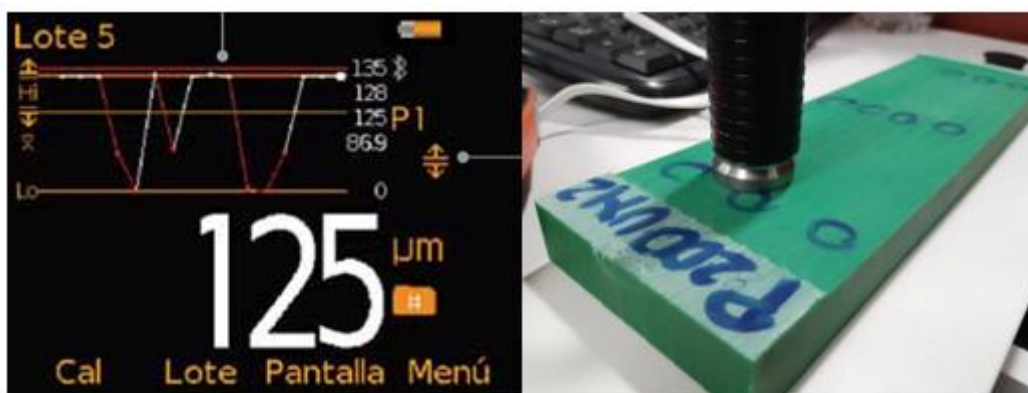
Figura 0-21 Proceso de medición de rugosidad a probetas
