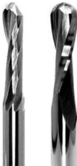
Figura 0-5 Fresas de punta esférica para fresado de plástico
