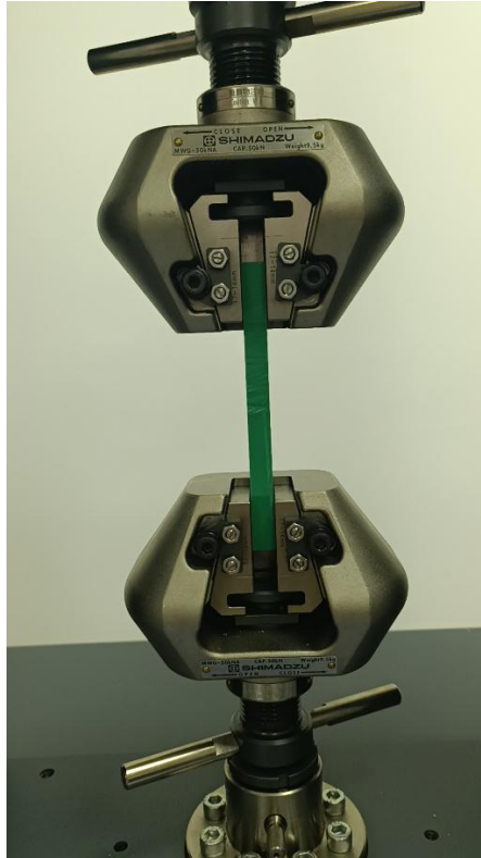
Figura 0-54 Probeta colocada en la maquina universal
