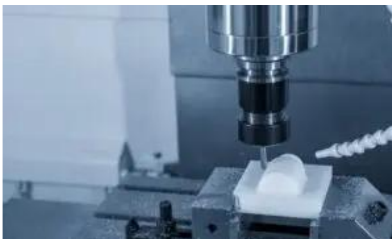
Figura 0-6. Fresado CNC en piezas plásticas
