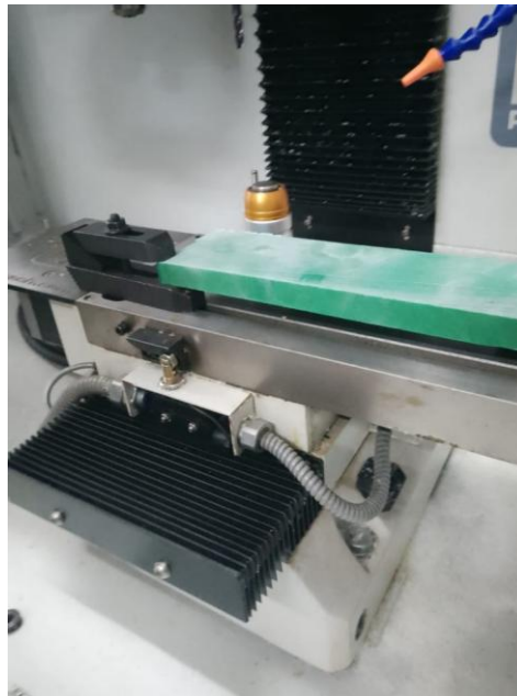
Figura 0-7 Corte de probetas en máquina CNC
