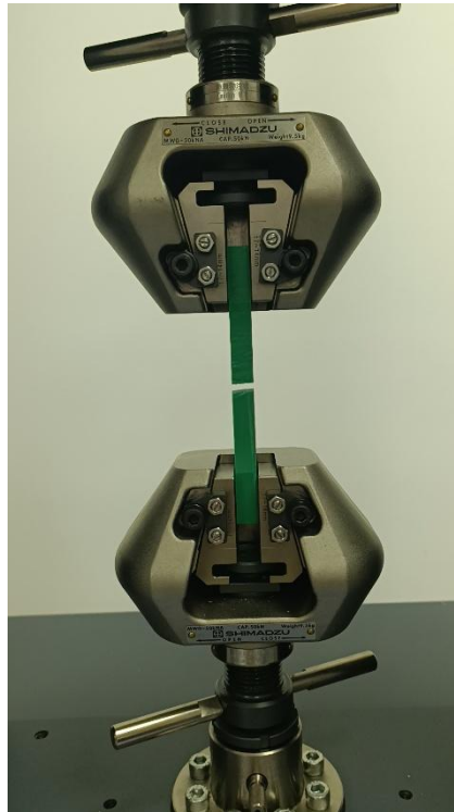
Figura 0-56 Rotura de probeta en máquina universal
