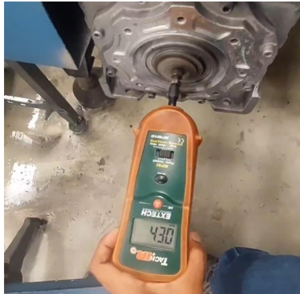
Figura 2.4 Velocidad a la salida del reductor medido con un tacómetro
