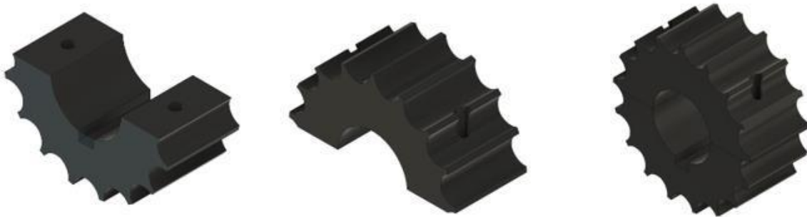
Figura 3.2 Diseño de piñón en Nylon 12
