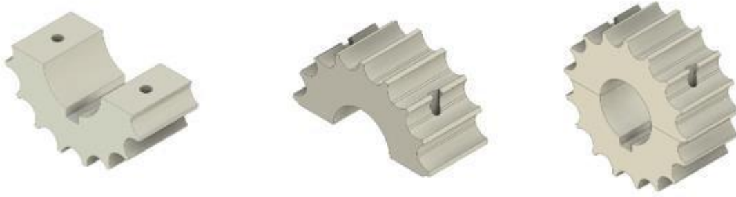
Figura 3.1 Diseño de piñón en Nylon 6
