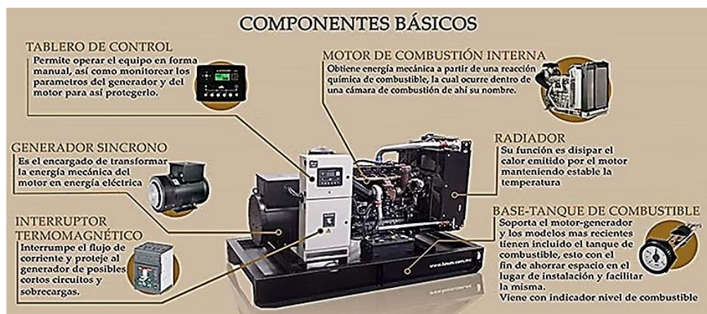
Figura 1.15 Componentes básicos del generador de diésel
