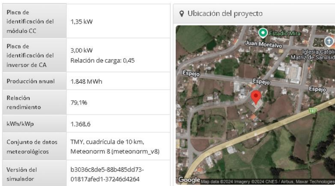
Figura 3.1 Características del sistema de acuerdo a la simulación en HelioScope
