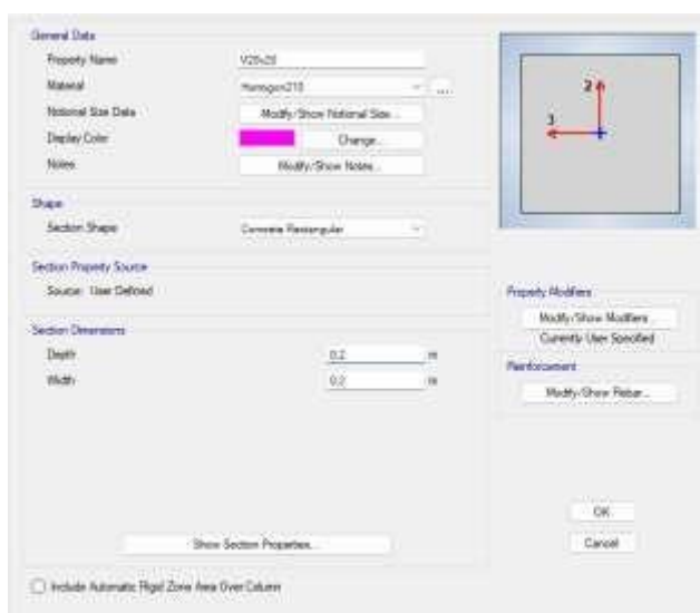
Figura 27: Definición de las dimensiones de la viga secundaria
