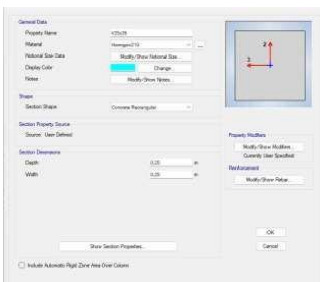
Figura 27: Definición de las dimensiones de la viga secundaria
