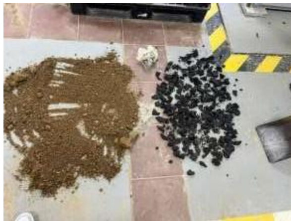
Figura 5: Muestras de suelo obtenidas de las calicatas realizadas en el sitio
