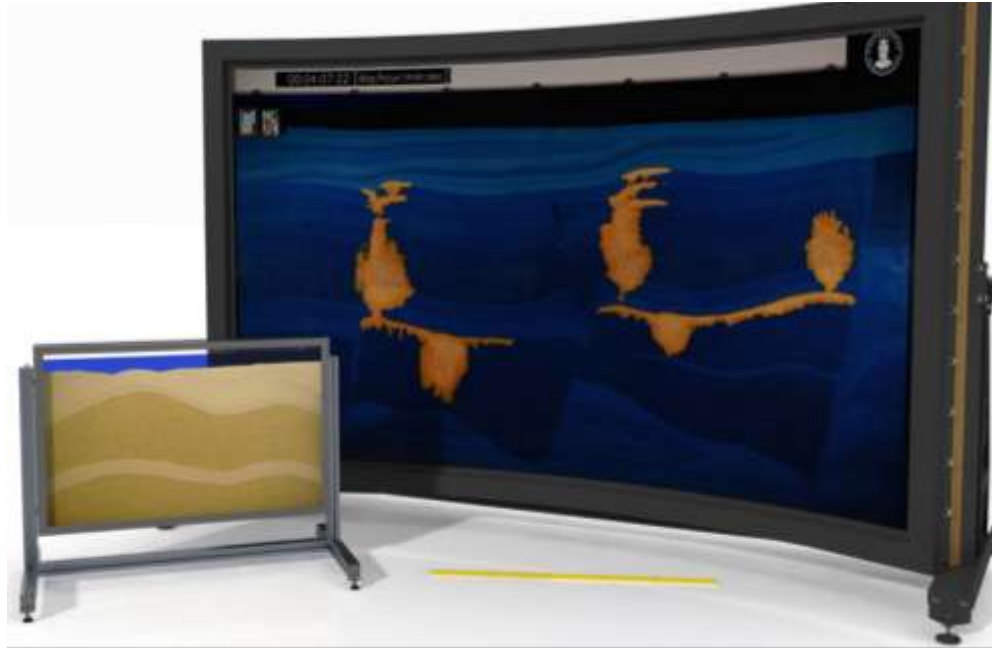
Figura 4. Herramienta a escala de laboratorio "FluidFlower"
