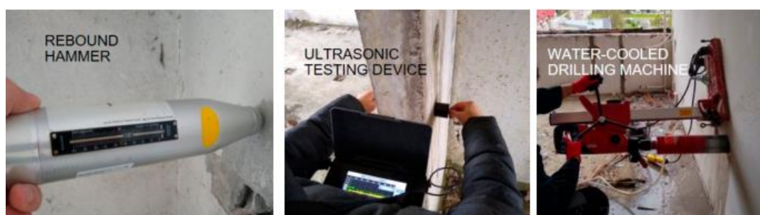
Figura 2-6. Métodos de inspección de concreto. Fuente: (Wardach & Krentowski, 2023).
