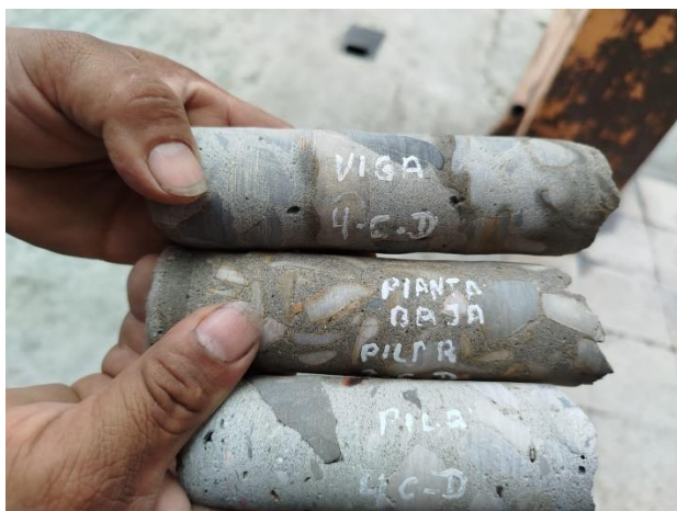
Figura 2-27: La imagen muestra tres núcleos obtenidos de las dos columnas y viga en estudio.
