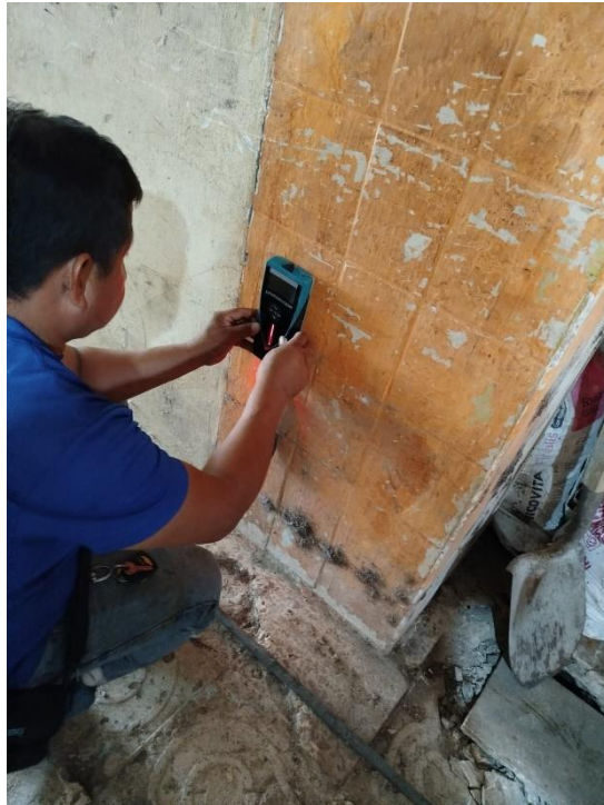
Figura 2-25 Ensayo de pachometria en una columna.
