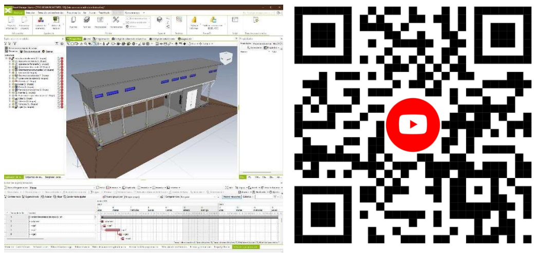
Figura 10. Modelo de simulación en secuencia y QR de la simulación Bexel Manager 24.
