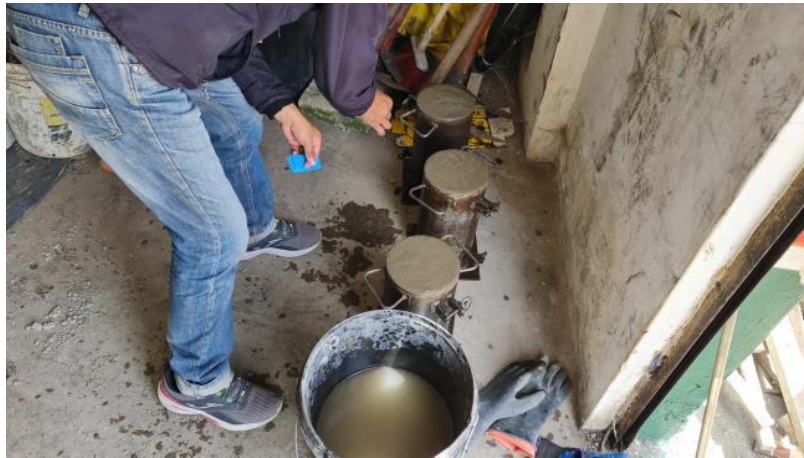
Gráfico 2.12 Elaboración de cilindros de hormigón para posterior determinar su resistencia a la compresión.
