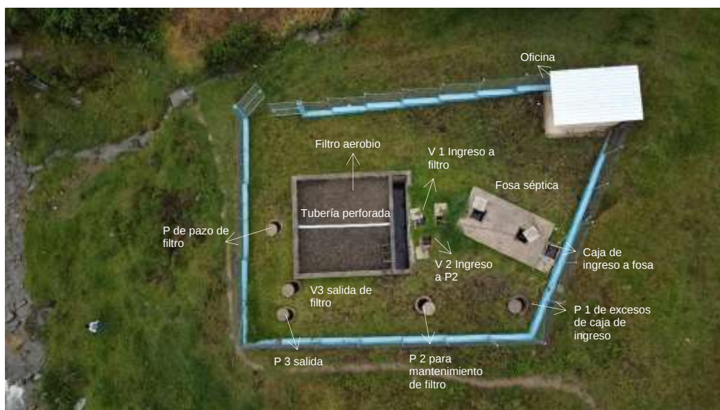
Figura 5 Vista en planta general de la PTAR
