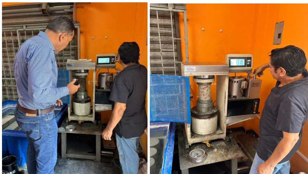
Figura 2.9 Ensayo de cilindros en laboratorio.
