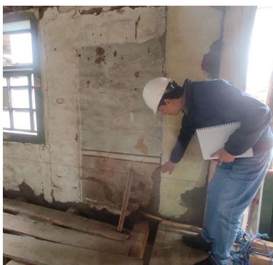
Figura 2.17: Selección de muestra de barro antiguo para ensayo de granulometría
