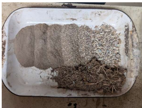
Figura 2.18: Material después del ensayo de granulometría
