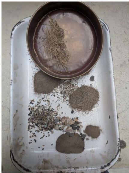
Figura 2.20: Material después del ensayo de granulometría
