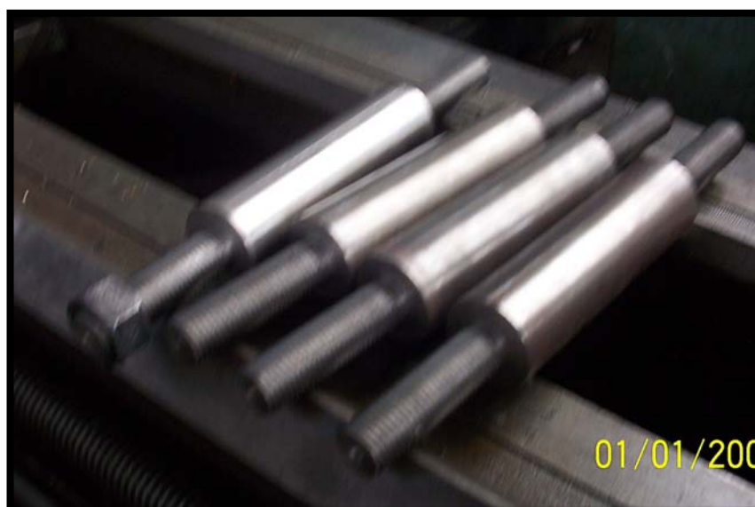
FIGURA 3.5 PERNOS PARA SOSTENER LA ESTRUCTURA
