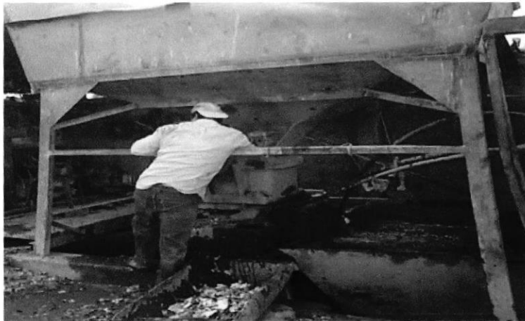
Fotografía 2.7. Tolva de recepción del vidrio
