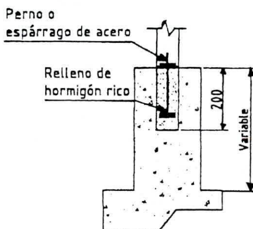
FIGURA 1. Anclaje de tanques
