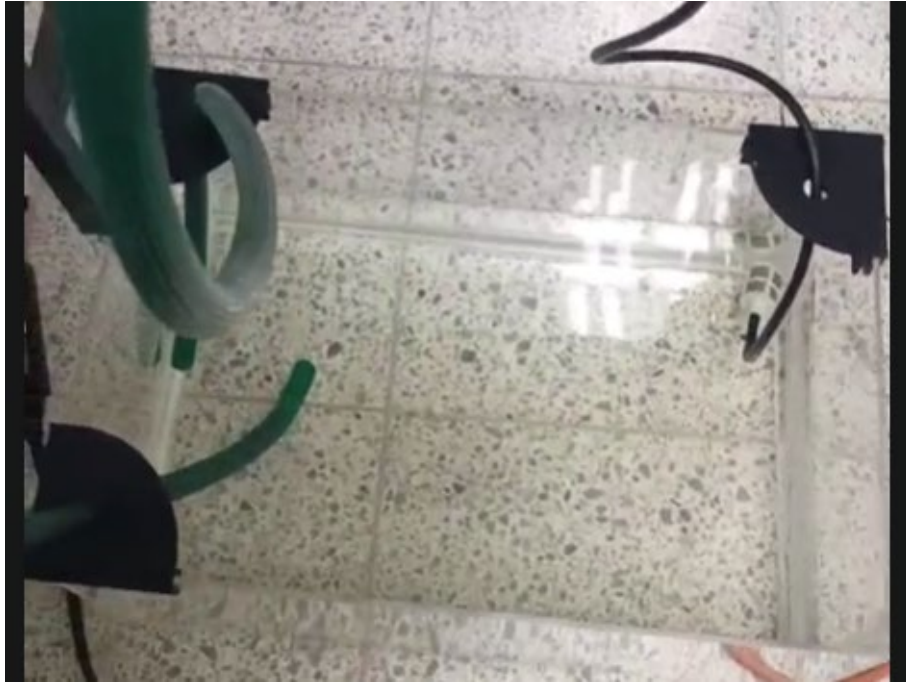
Figura 2.15 Reservorio con mangueras de succión y descarga instaladas
