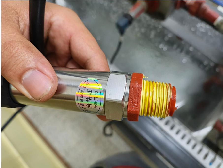
Figura 2.13 Reducciones instaladas en sensores industriales
