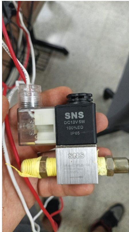
Figura 2.14 Reducciones instaladas en válvulas proporcionales
