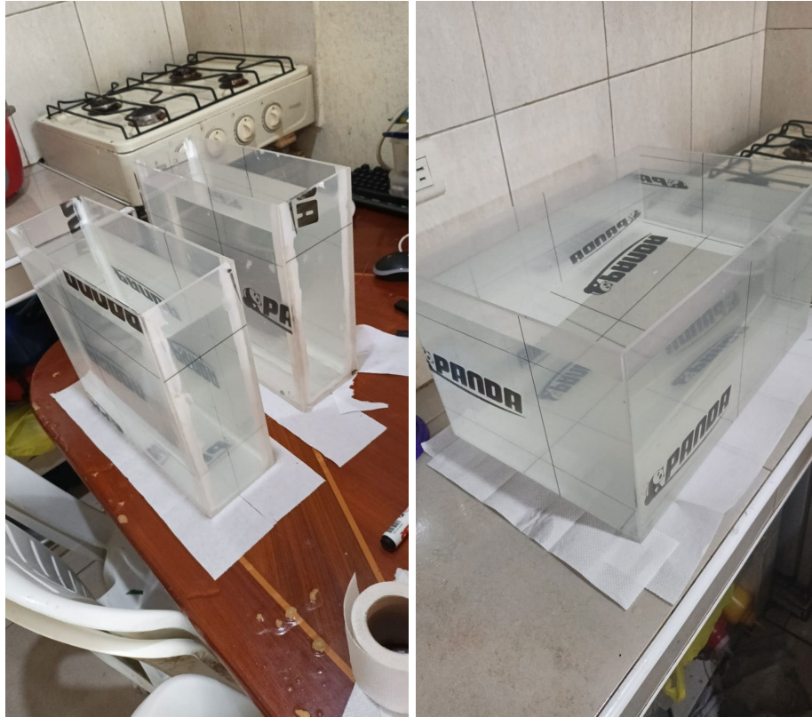
Figura 2.9 Pruebas de estanqueidad de tanques de acrílico
