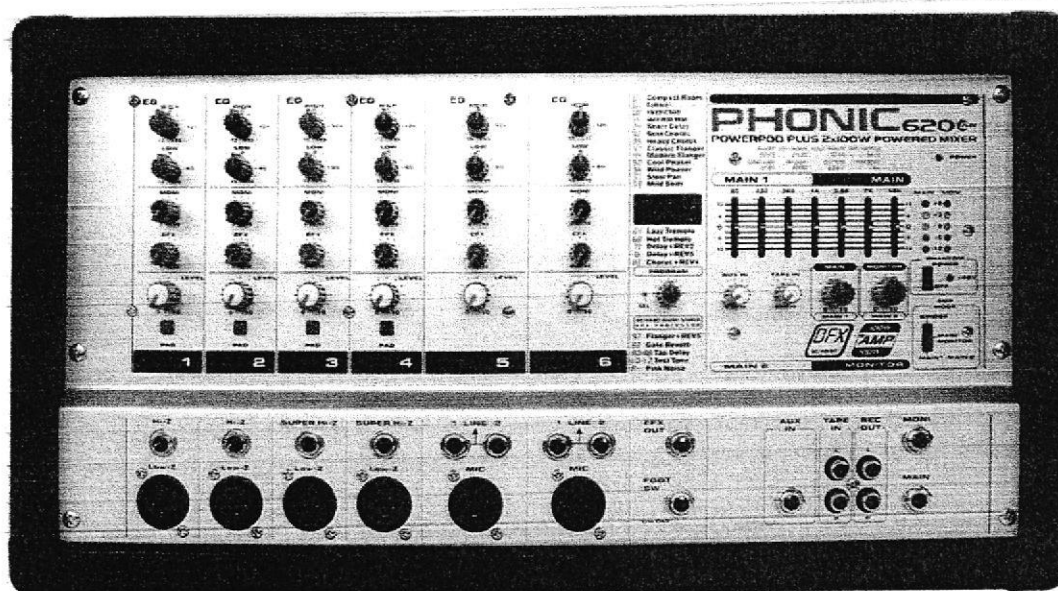
Amplificador 200 WRMS – MONO. PHONIC POWERPOD 620 PLUS
