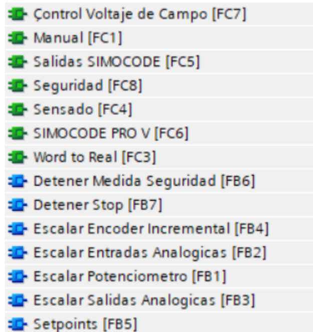
Figura 2.9 Bloques funcionales implementados en TIA Portal
