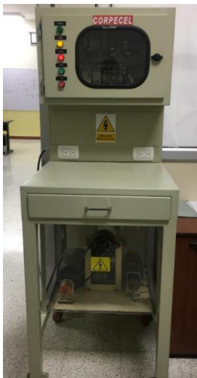
Figura 8. Planta experimental de generación eléctrica utilizada en la práctica.
