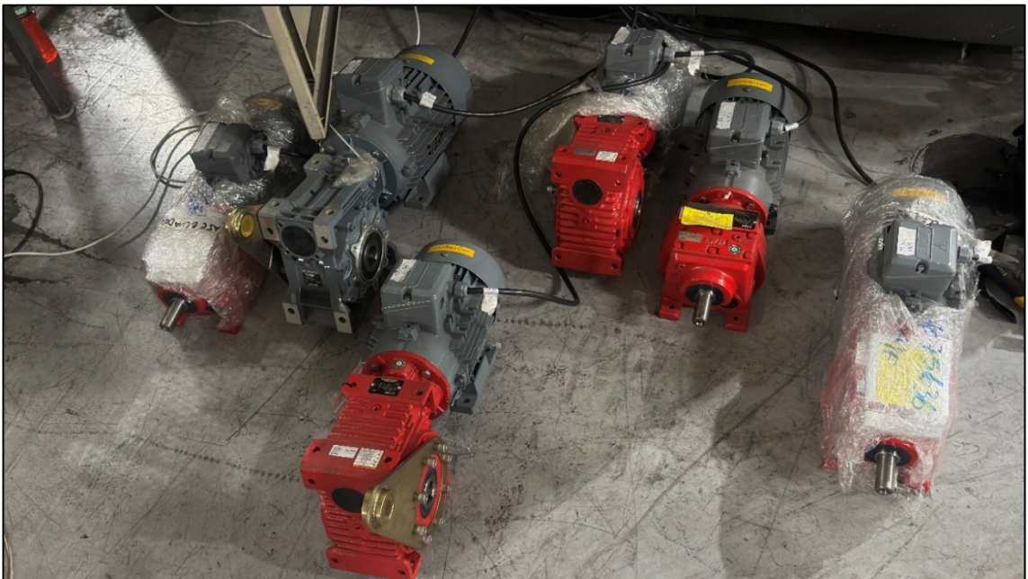
Fig. 2.61 Motores conectados para prueba de operación simultánea.
