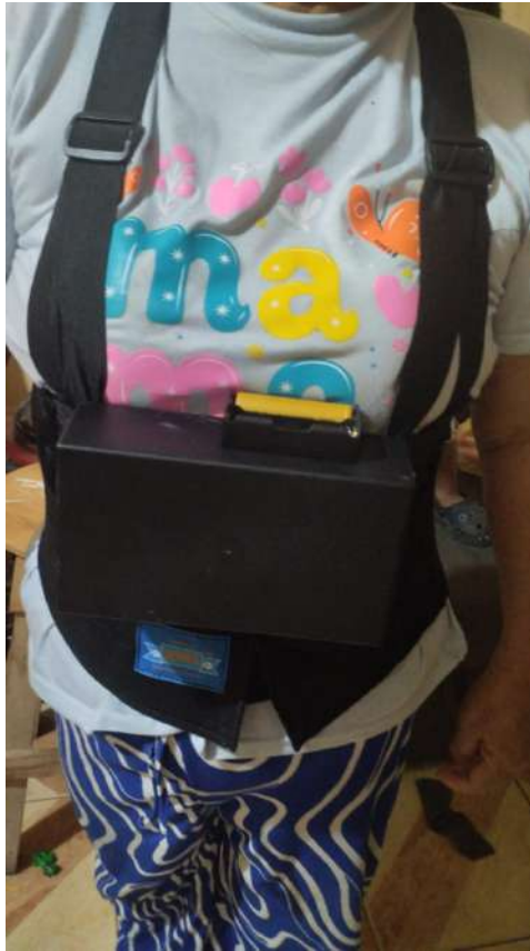
Figura 3.10. Prototipo del cinturón térmico con sensor y actuador
