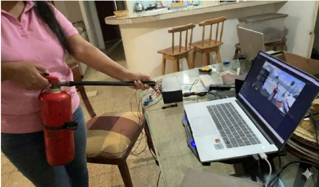
Figura 3.11. Prototipo del extintor instrumentado con electrónica interna
