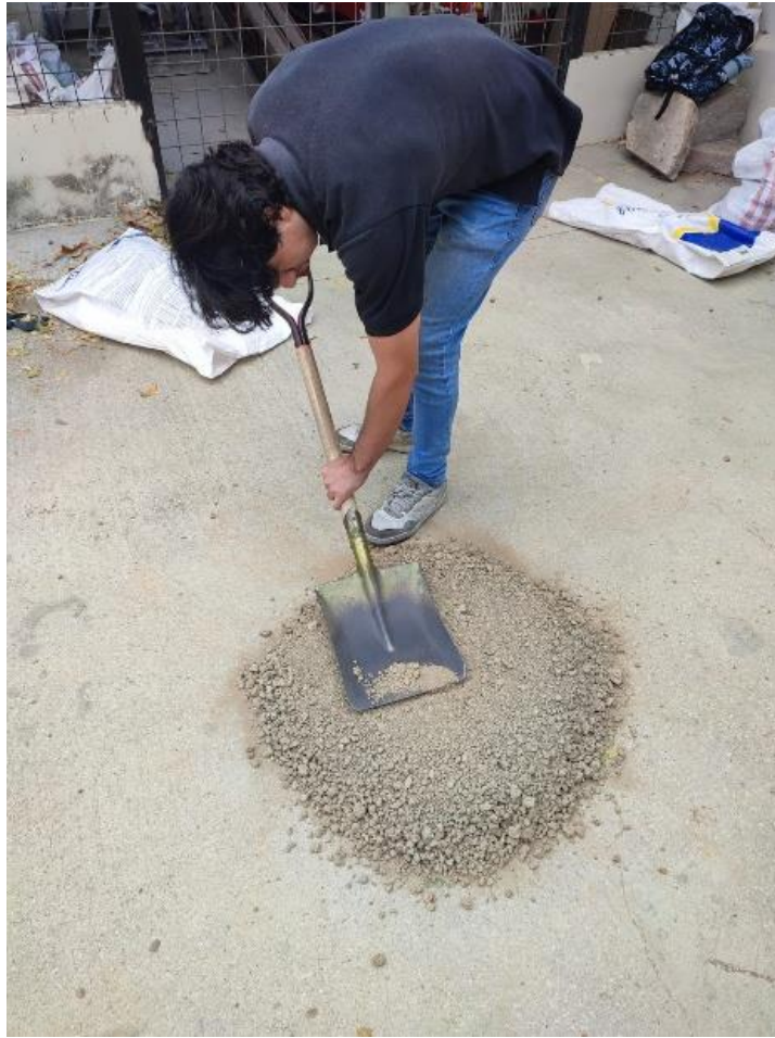
Figura 11. Cuarteo de muestra
