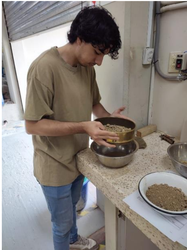
Figura 19. Toma de muestra para ensayo Límites de Atterberg
