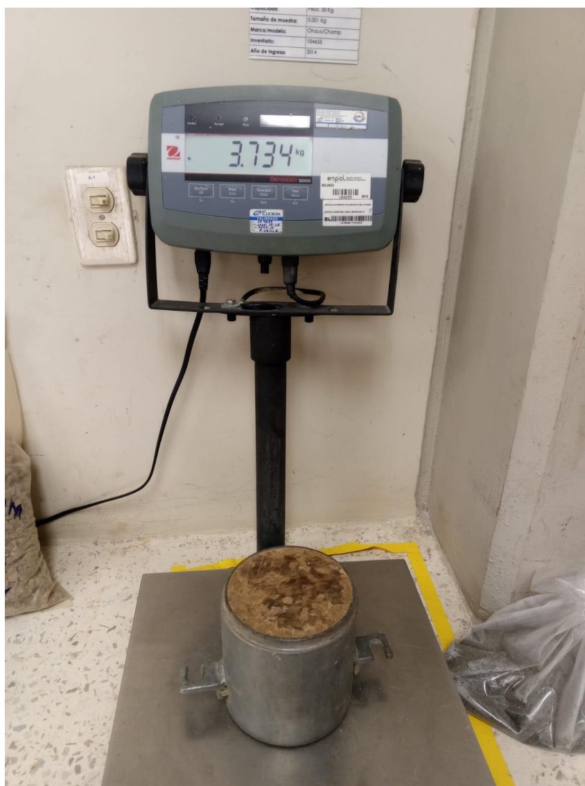
Figura 26. Toma de peso de molde más muestra compactada
