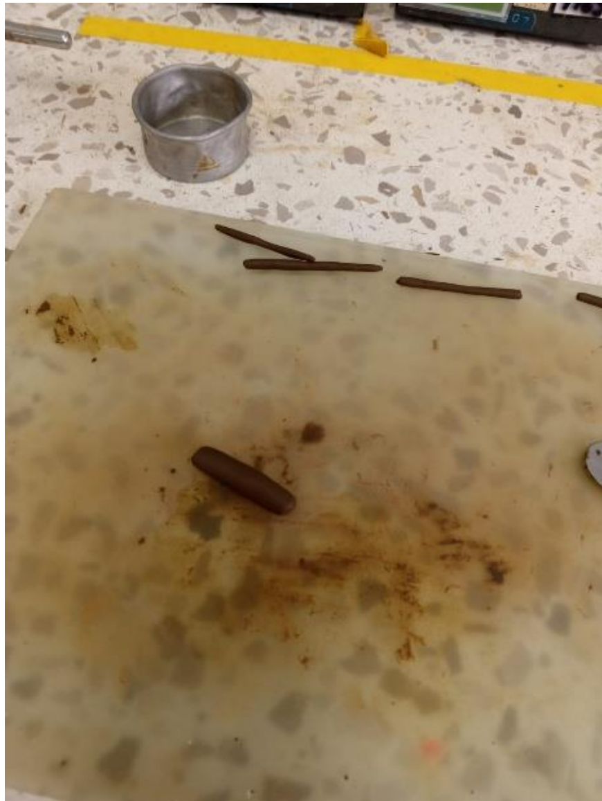
Figura 21. Muestra para Límite Plástico
