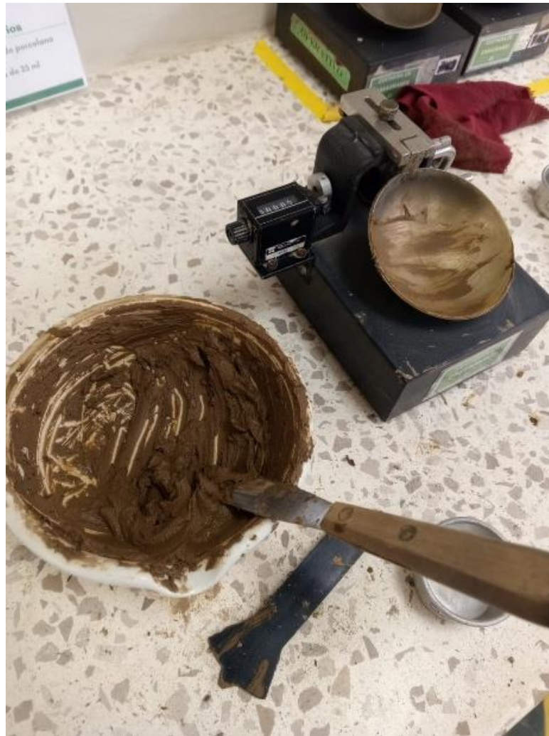
Figura 20. Mezcla de muestra y colocación en Copa Casagrande
