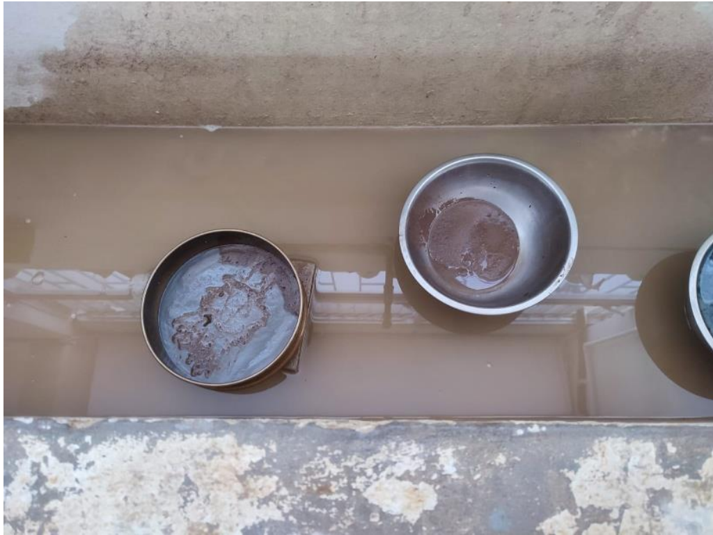
Figura 12. Lavado de muestra para ensayo de Granulometría
