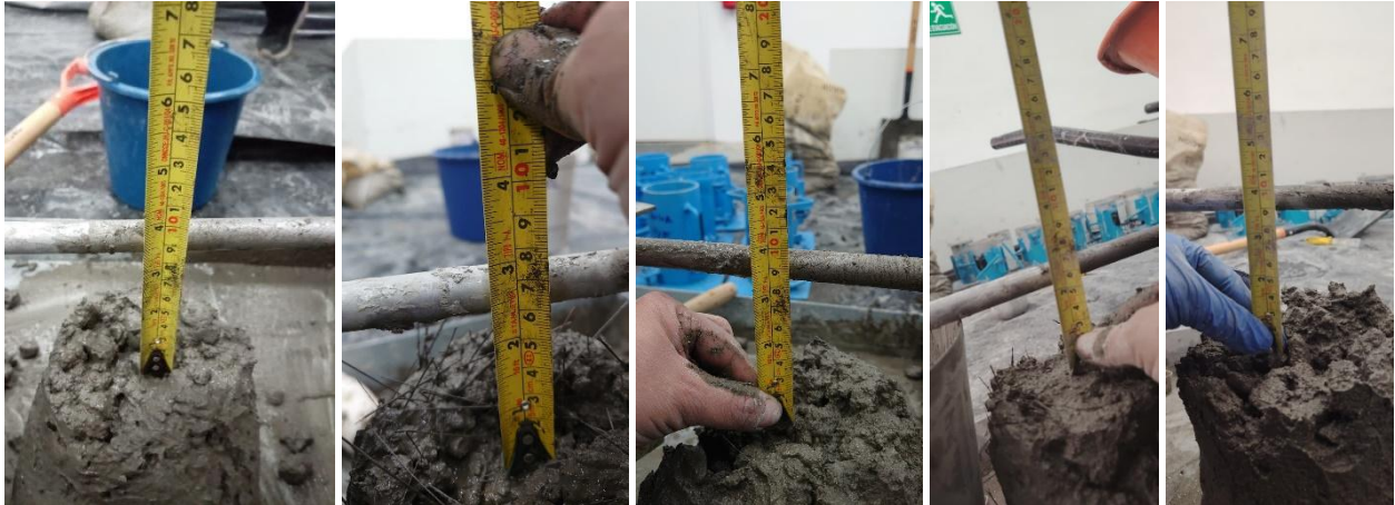
Figura 2.13 Control de asentamiento de las dosificaciones en estado fresco
