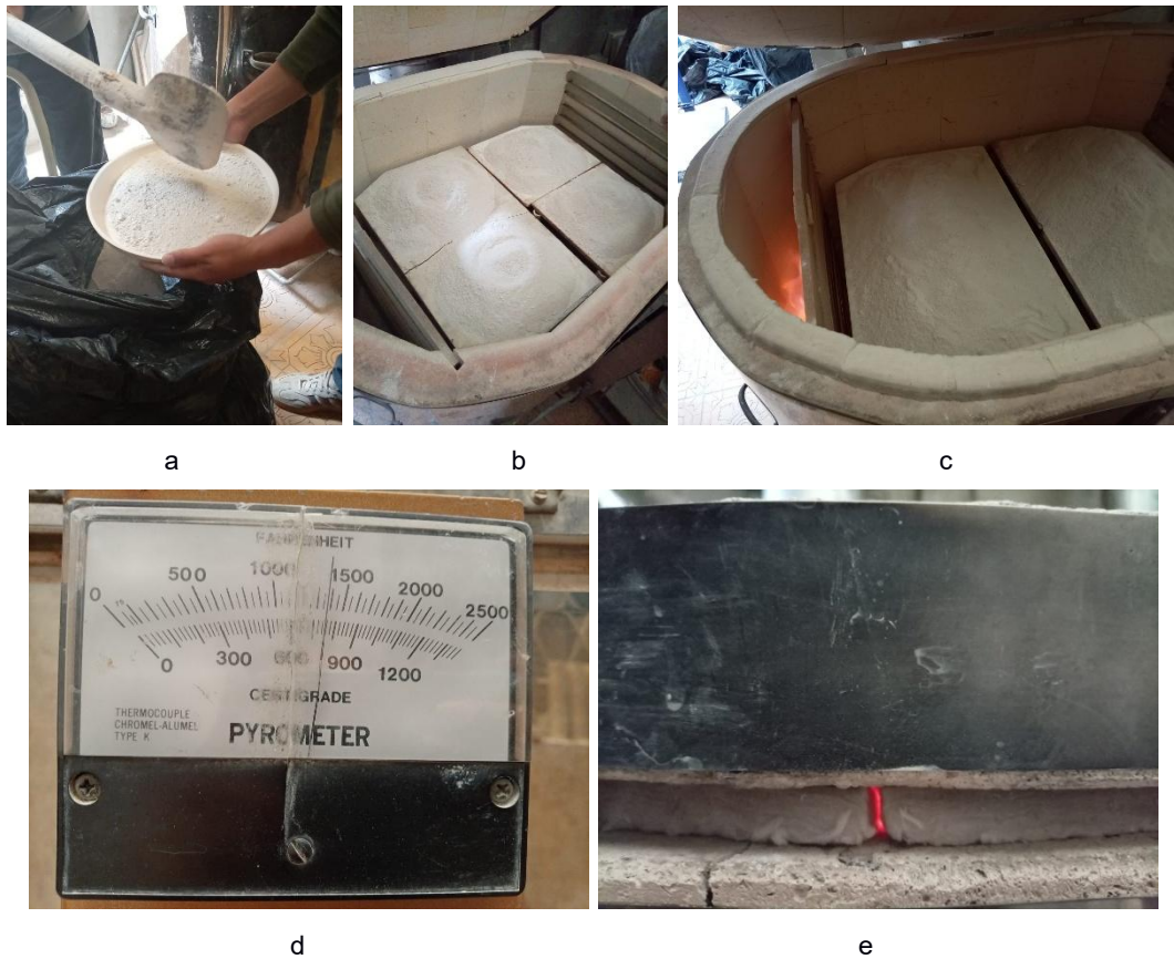
Figura 2.7 Calcinación masiva de la arcilla natural: (a) Colocación de muestra natural, (b) Distribución uniforme de la muestra natural en el volumen total del horno, (c) Encendido de quemadores, (d) Control de temperatura, (e) Sellado del horno, presencia de alta
