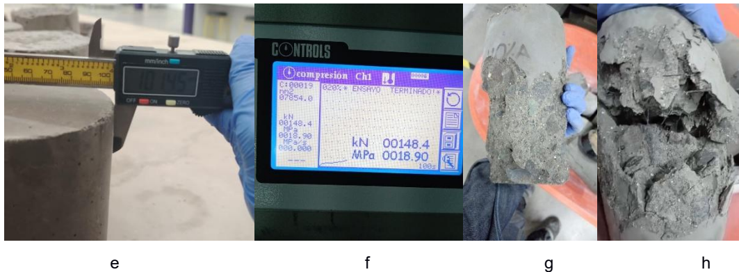
Figura 3.27 Ensayo de Compresión de Cilindros de hormigón: (a) control de perpendicularidad de la probeta, (b) control de planicidad de la probeta, (c) equipo usado para control de calidad, (d) probeta con fibra ensayada, (e) toma de medidas de diámetros, (f) resultados en la pantalla de la máquina, (g) estado de la probeta posterior al ensayo
