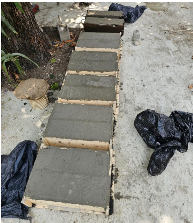
Anexo 5 Moldeado de probetas de vigas- Previo a la realización del ensayo a flexión
