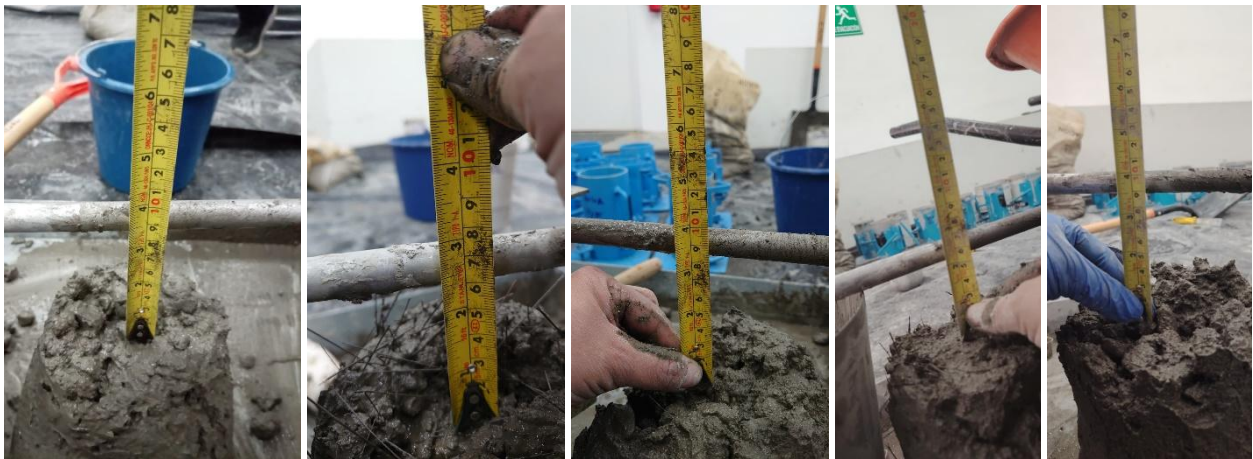
Figura 3.24 Control de asentamiento de las dosificaciones en estado fresco
