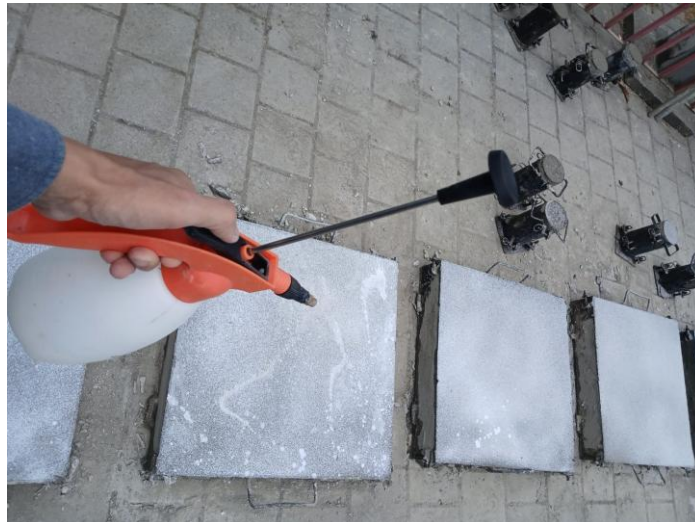
Figura 2.31 Curado inicial de placas y cilindros
