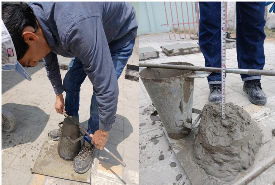
Figura 2.27 Medición de trabajabilidad según ensayo de Cono de Abrams
