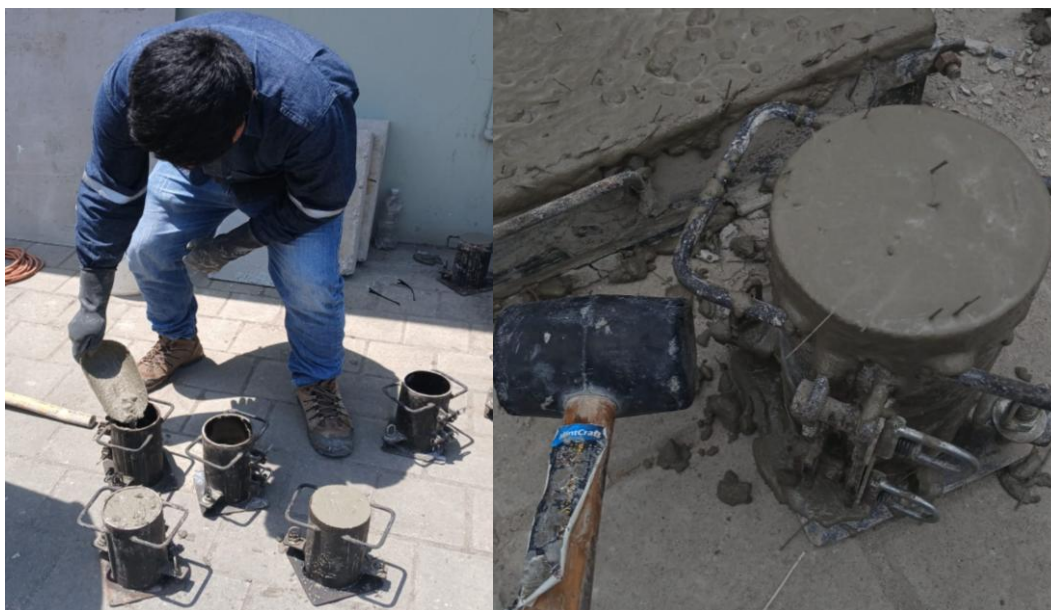
Figura 2.28 Moldeo de cilindros. Vertido del hormigón (izquierda), golpes con martillo (derecha)
