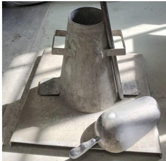
Figura 2.19 Cono de Abrams Fuente: Elaboración propia
