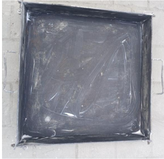
Figura 2.17 Molde metálico para las placas Fuente: Elaboración propia
