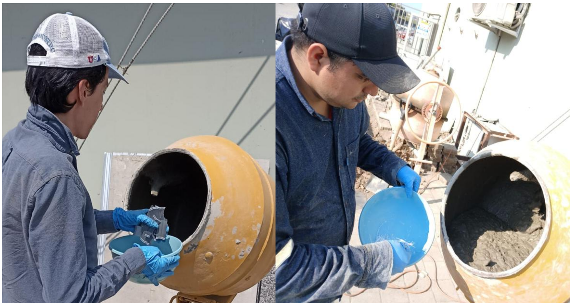
Figura 2.25 Incorporación de fibras de acero (izquierda) y fibras de polipropileno (derecha)
