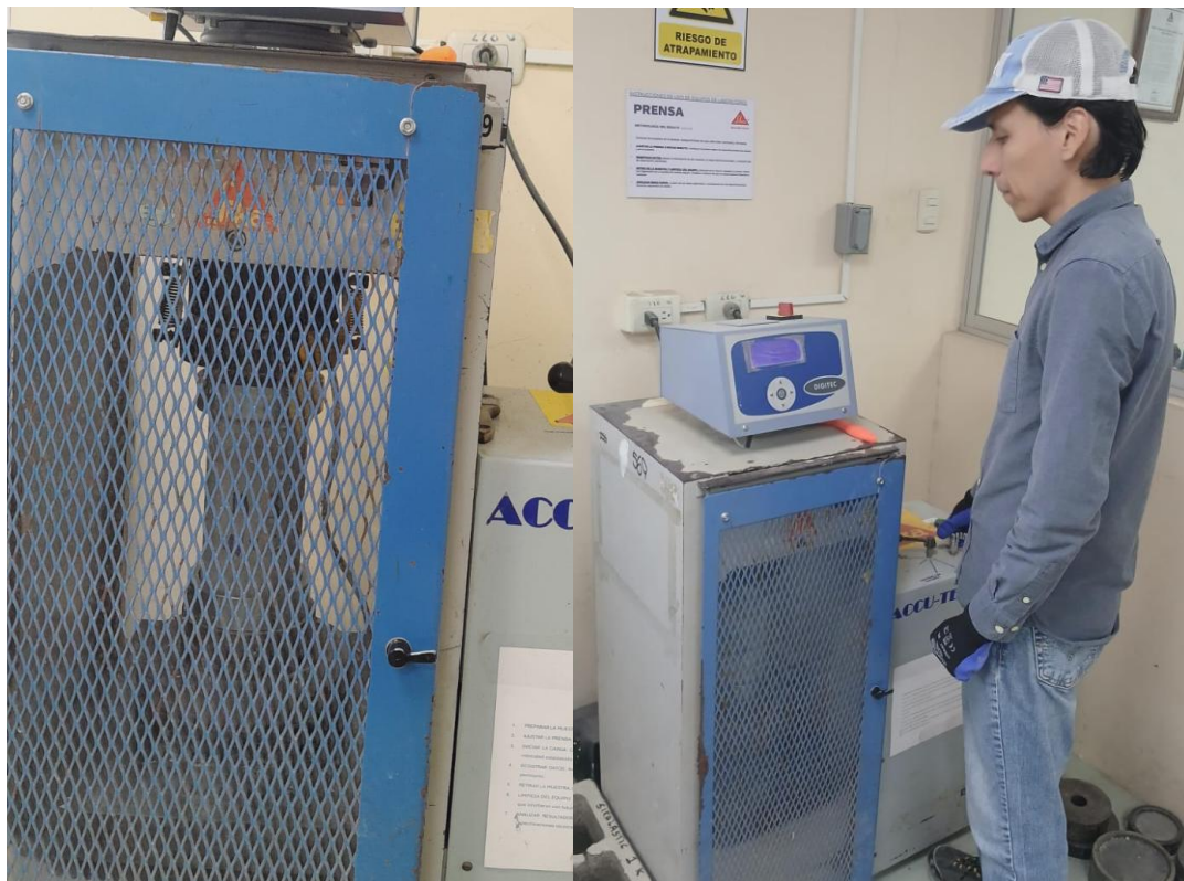
Figura 2.39 Ajuste de prensa (izquierda), aplicación de la fuerza (derecha).
