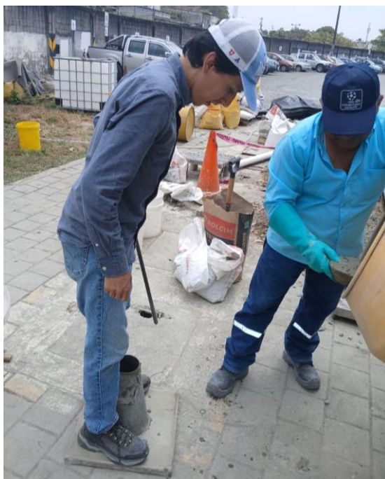
Figura 2.40 Preparación para realizar el ensayo de trabajabilidad
