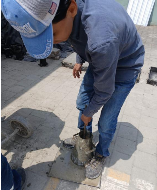
Figura 2.42 Apisonado de cada capa de hormigón con la varilla metálica.
