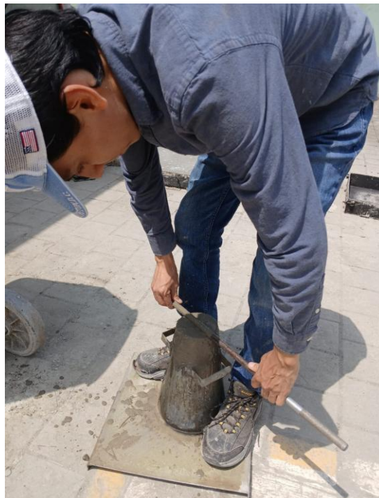
Figura 2.43 Enrasado de la superficie con la varilla metálica.
