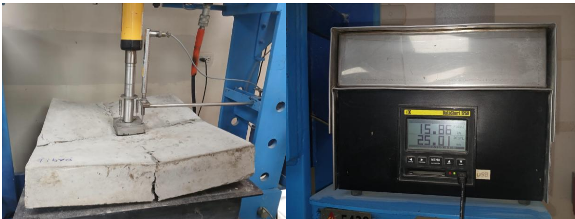
Figura 2.37 Terminación del ensayo a \delta=25\pm 1\text{mm} .
