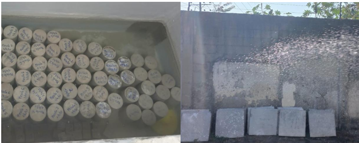
Figura 2.33 Curado de cilindros (izquierda), curado de placas (derecha)
