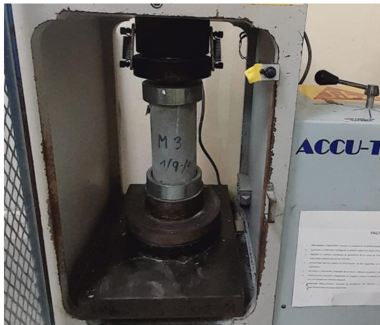
Figura 2.38 Colocación del cilindro en la prensa.
