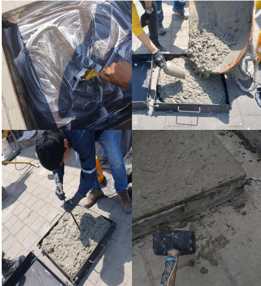
Figura 2.29 Moldeo de placas. Desencofrante (superior izquierda), vertido del hormigón (superior derecha), apisonamiento con varilla (inferior izquierda), golpes con martillo (inferior derecha)
