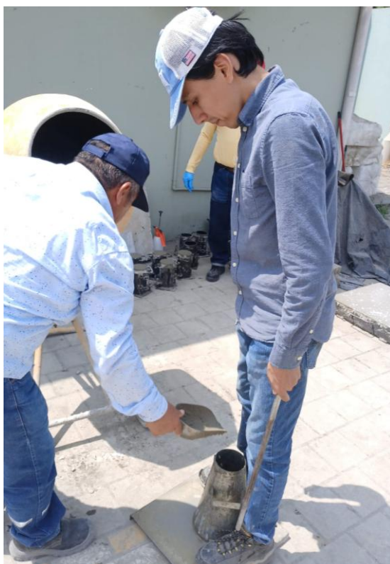
Figura 2.41 Vertido de cada capa de hormigón en el cono.
