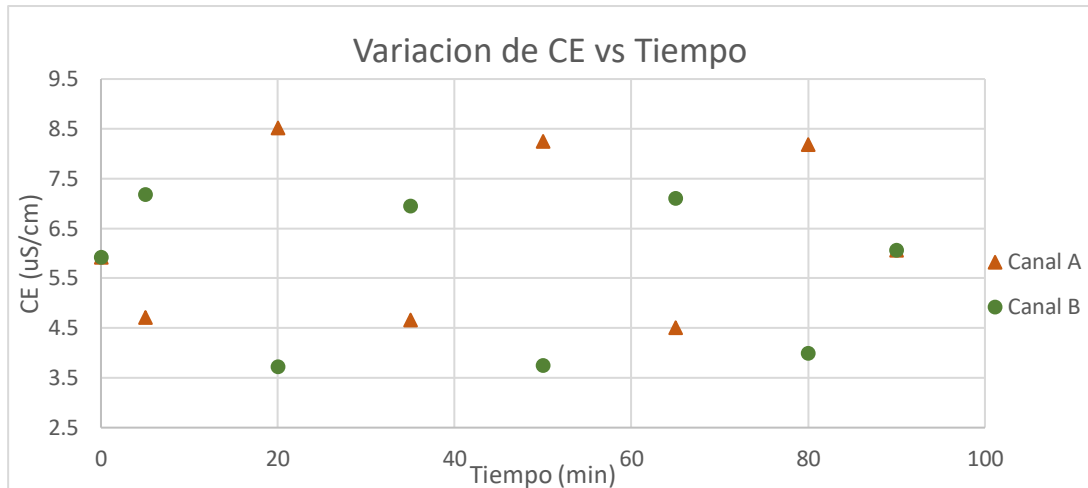
Figura 11: Variación de CE vs Tiempo (4.5 V-400ml/min)
