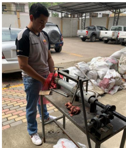
Figura 22. Extracción de la muestra de suelo del tubo Shelby
