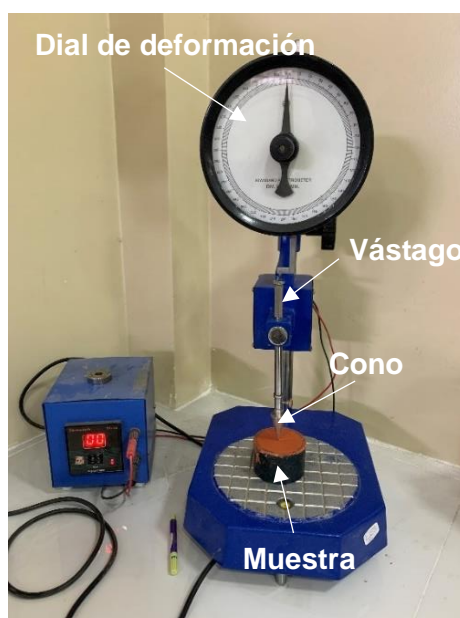
Figura 9. Partes básicas de un penetrómetro
