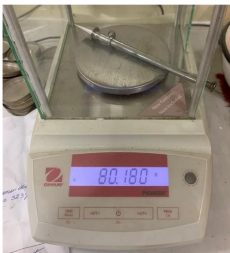
Figura 23. Peso del cono y vástago calibrado
