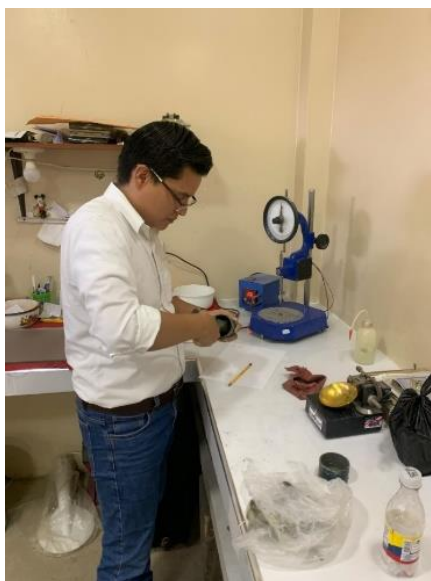
Figura 19. Ejecución del ensayo Caída de Cono
