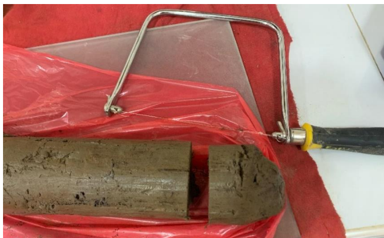
Figura 17. Seccionado de la muestra
