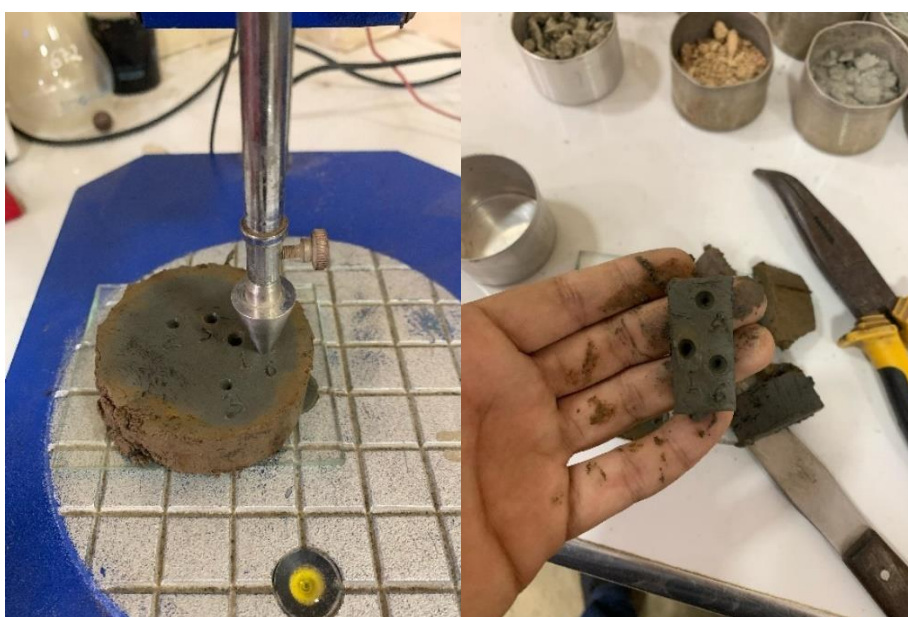
Figura 18. Penetración en muestra inalterada
