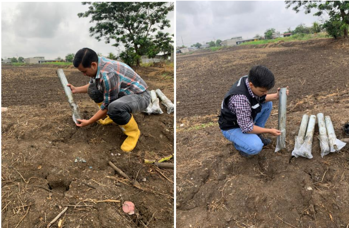
Figura 21. Muestreo con tubos Shelby
