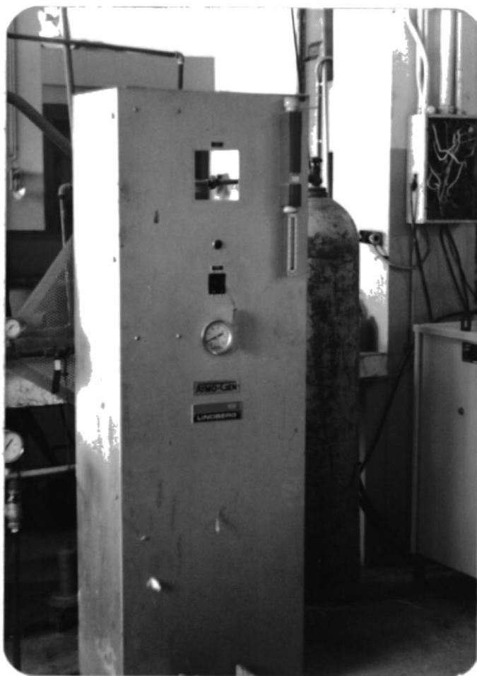
Fig. 2.3.- Generador de Atmósfera ATMO GEN, Modelo LAM 100, marca LINDBERG
