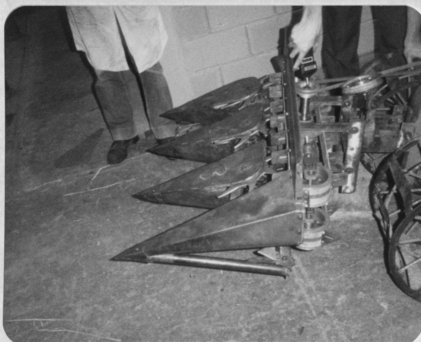
Foto # 10 MEDICION DE REVOLUCIONES AL EJE PRINCIPAL.
