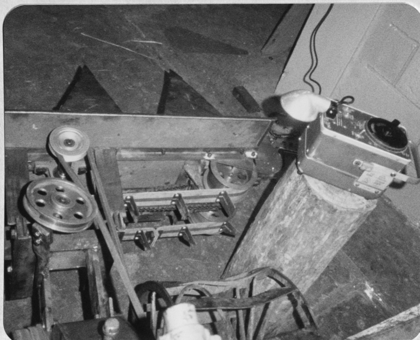
Foto # 12 COMPROBACION DE REVOLUCIONES CON EL ESTROBOSCOPIO.
