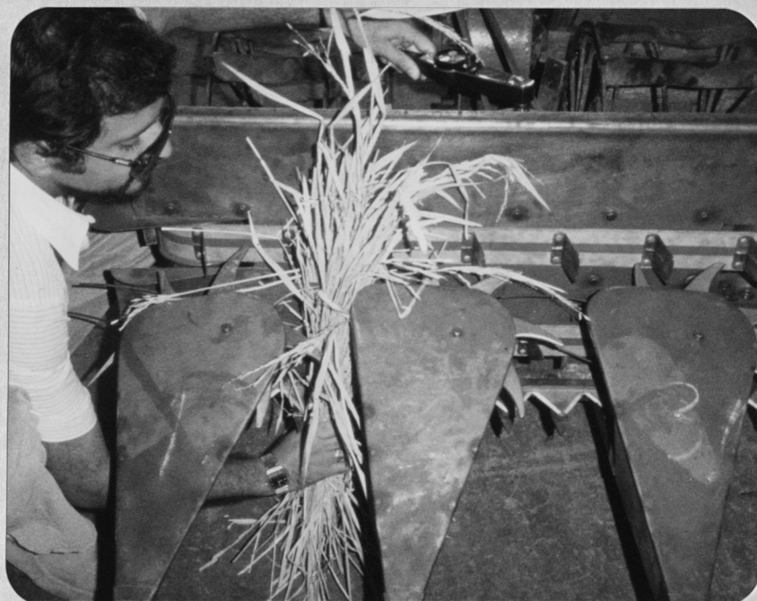
Foto # 9 MEDICION DEL TORQUE CON CARGA PARCIAL.
