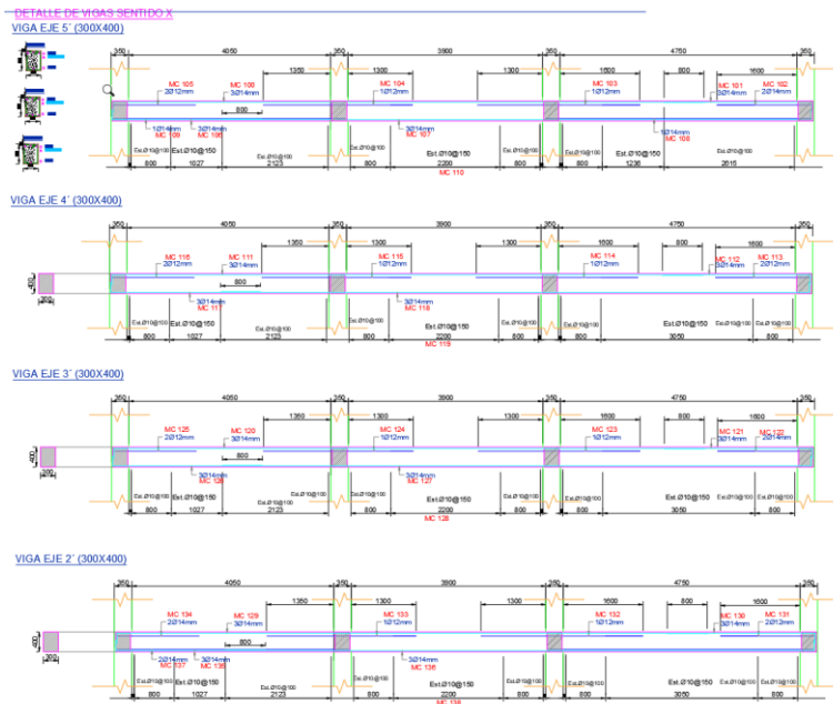
Figura 2.40: Viga dirección X, planta alta 1
