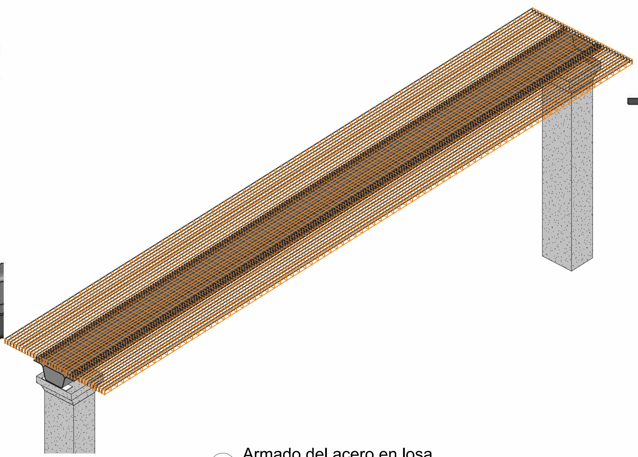
3 Refuerzo en losa 1 : 10
