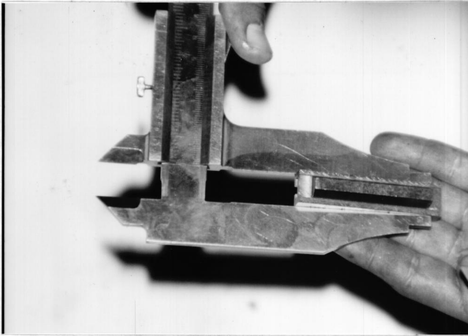
FOTOGRAFIA NO. 3,9.- Calibración del regulador de carrera.
