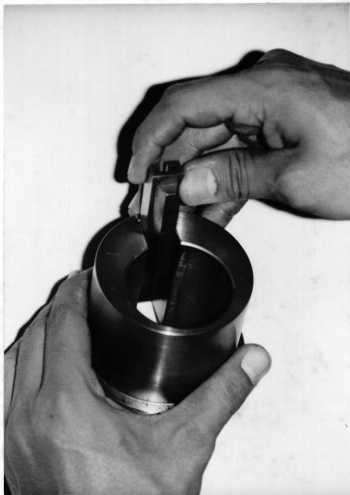
FOTOGRAFIA NO. 3.11.- Monta je del sistema de regulación de carrera.
