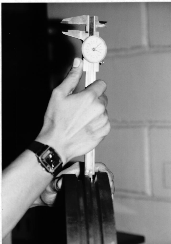
FOTOGRAFIA NO. 3.3.- Verificación del volante, canales.
