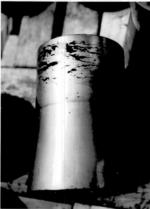
FIGURA 4.- MOLDES DETERIORADOS POR ABRASION, CORROSION Y MALTRATO.
