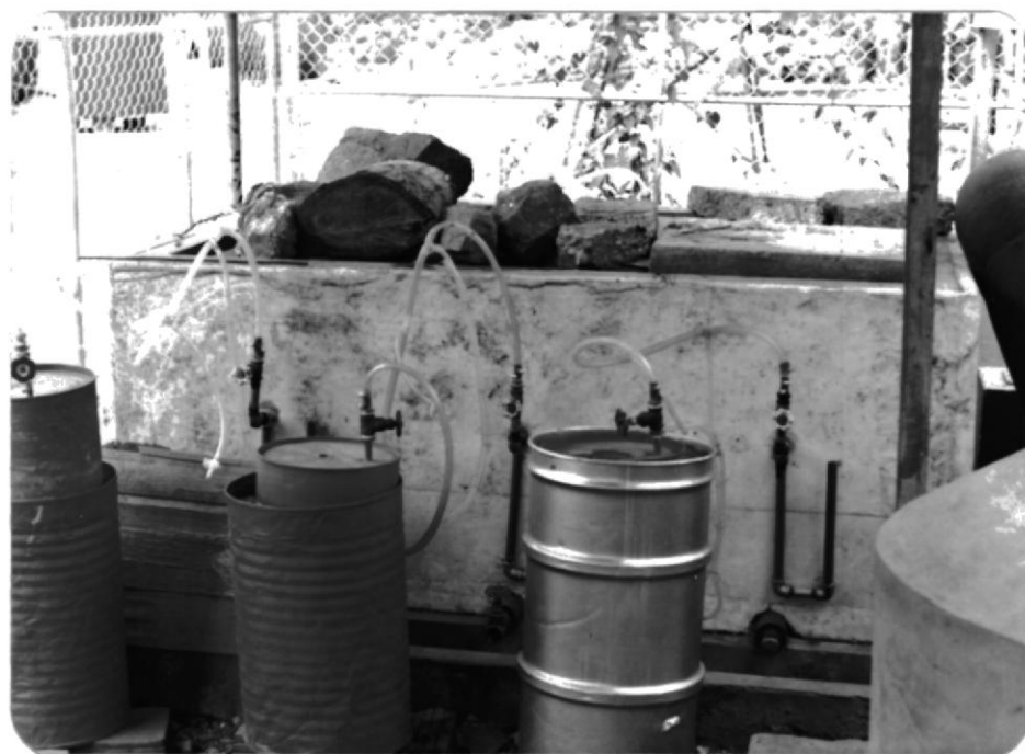
VISTA FRONTAL DE BATERIA MINIDIGESTORES
