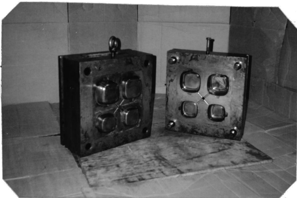
Foto # 10 EL molde de Inyección
