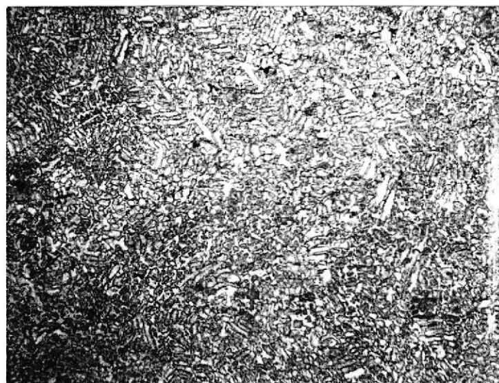
FIG. No. 14: Microestructura observada en la aleación ZA-8
