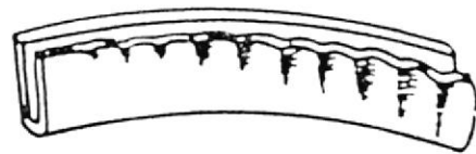
Figura 14. Arrugas del gancho de la tapa.
