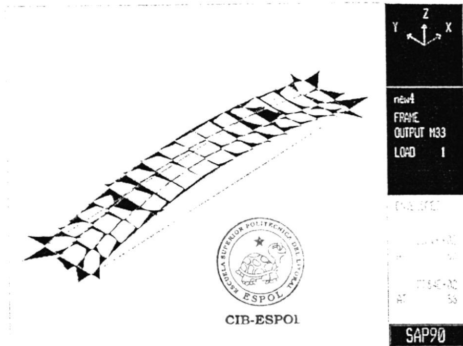
FIGURA 3.9 DIAGRAMA DE FUERZAS GENERADAS EN EL PISO DEL PUENTE
