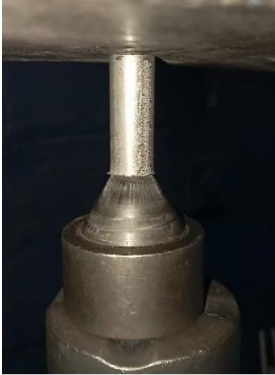
Figura 7: Ensayo de abocardado
