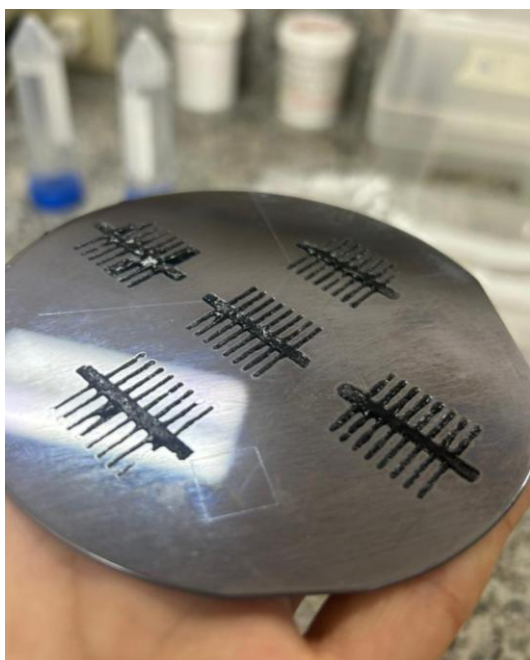
Figura 19. Resultado del sustrato oblea de Si + Pasta conductora de SWCNTs
