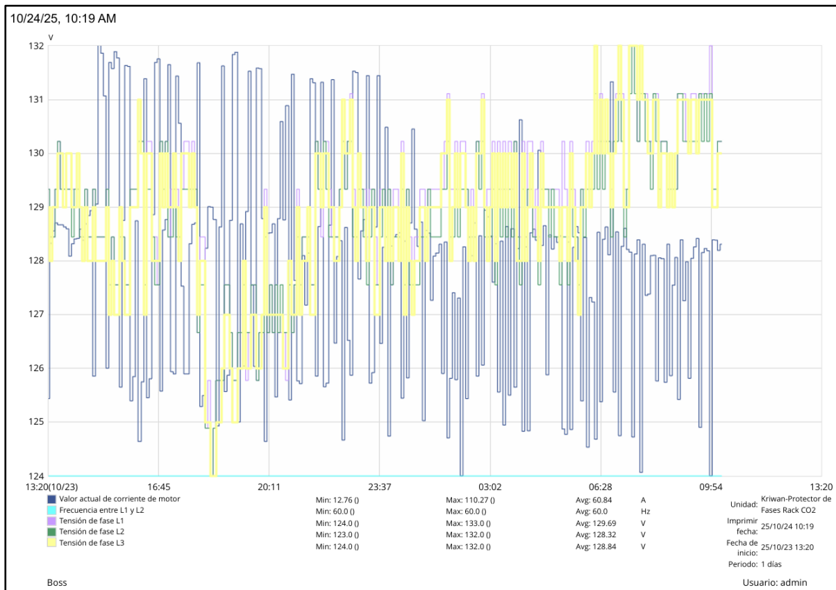
Figura 67 Datos de consumo de energía del rack de compresores.
