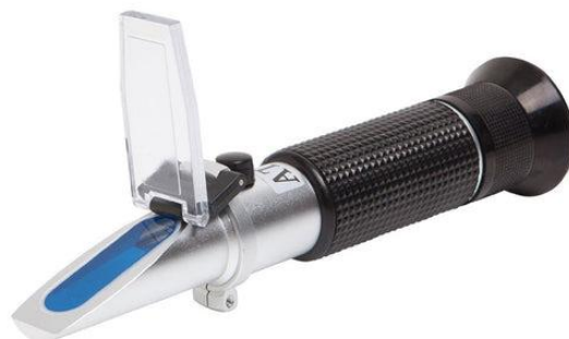
Figura 6 Refractómetro (medición de concentración de glicol en el sistema de agua)
