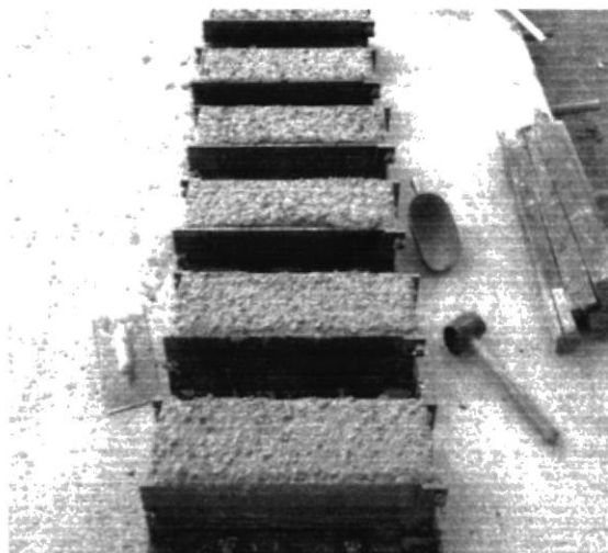
FOTO 3.14 Compactado de la segunda capa de las vigas
