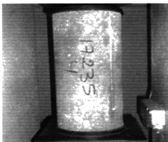
FOTO 2.7 Mínimos defectos superficiales
