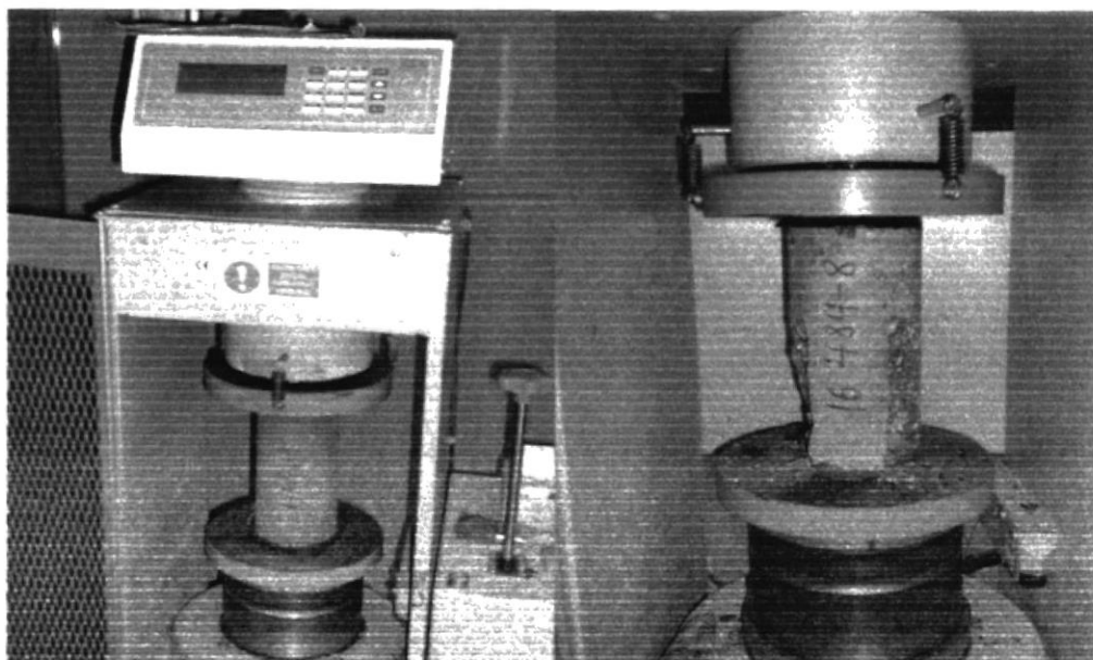
FOTO 3.22 Procedimiento de rotura (ASTM C39) de muestras de Hormigón
