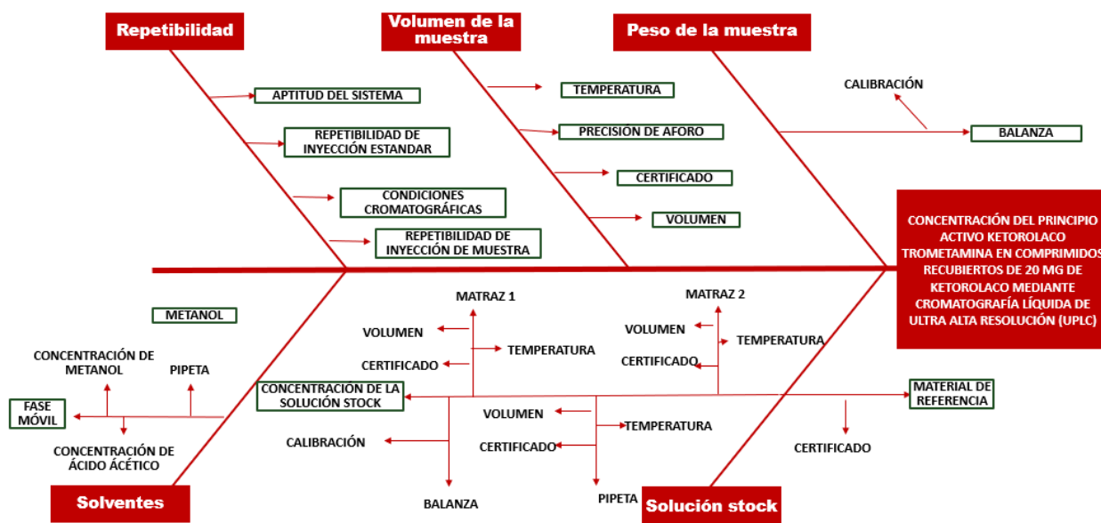
Figura F.1 Diagrama Ishikawa de las fuentes que afectan a la incertidumbre de medición en el análisis de determinación de Ketorolaco trometamina
