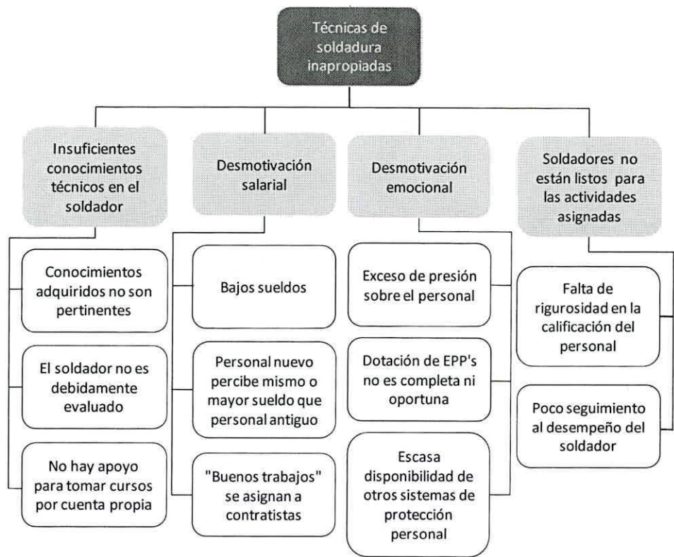
Figura 20. Aplicación de Técnicas de Soldadura Inapropiadas-Causas
