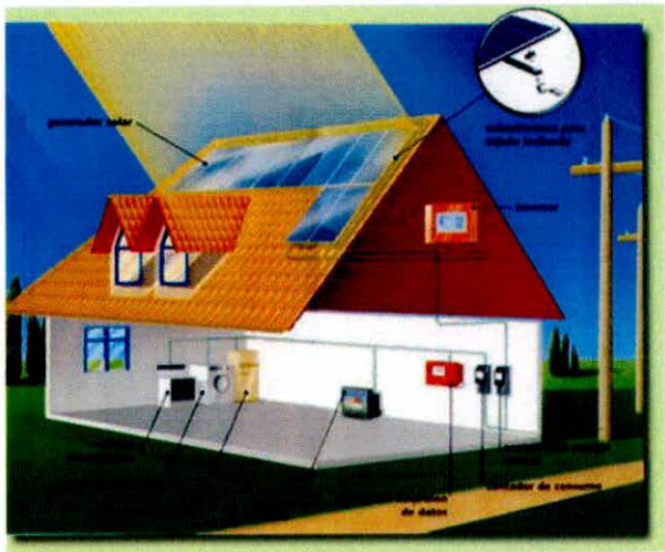
Grafico 9.- Esquema de Conexión del sistemas fotovoltaico
