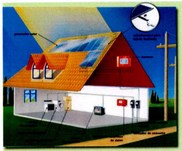
Grafico 9.- Esquema de Conexión del sistemas fotovoltaico
