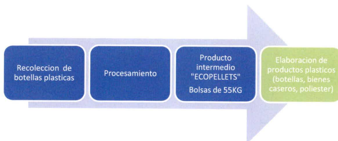
Gráfica 8.0. Proceso Reciclaje PET ECOPELLETS. Fuente de elaboración propia.
