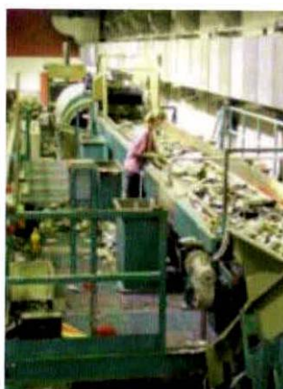
Gráfica 8.2.- Cinta de transportación para clasificación y separación
