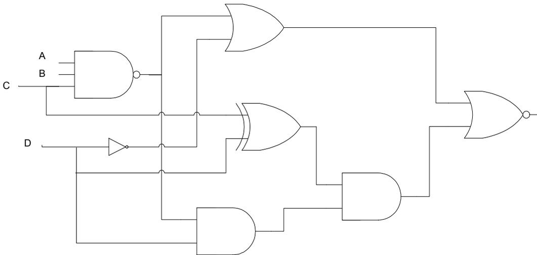
Establezca el nivel de voltaje a la salida para las siguientes combinaciones en las entradas: A.L, B.L, C.H, D.H.
