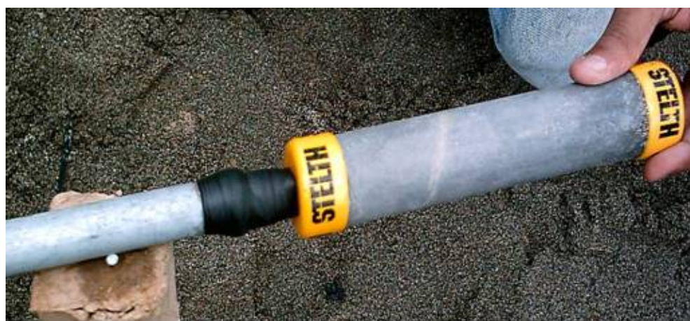
FIGURA 3.1 ELECTRODO DE REFERENCIA PERMANENTE \text{Cu}/\text{CuSO}_4 JUNTO CON SU TUBO RÍGIDO GALVANIZADO
