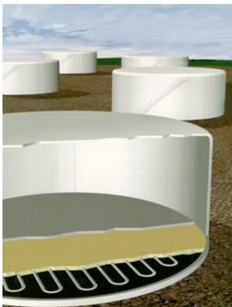
FIGURA 1.1 ANODOS DE ZINC USADOS PARA PROTECCION DE AST's
